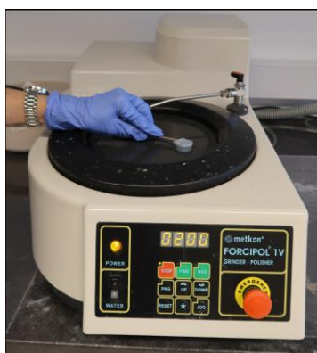
Slika 16. Mehanička obrada elektroda na uređaju Metkon Forcipol 1V
