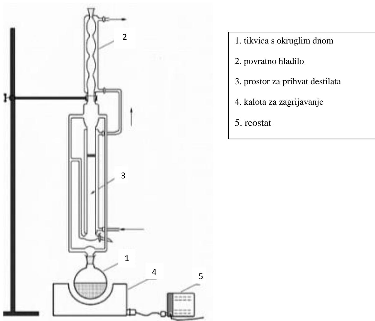
Slika 9. Shematizacija modificirane aparature prema Clevenger-u.<sup>8</sup>
