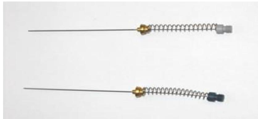
**Slika 8.** Vlakna s ovojnicama DVB/CAR/PDMS (sivo vlakno) i PDMS/DVB (plavo vlakno)<sup>21</sup>
