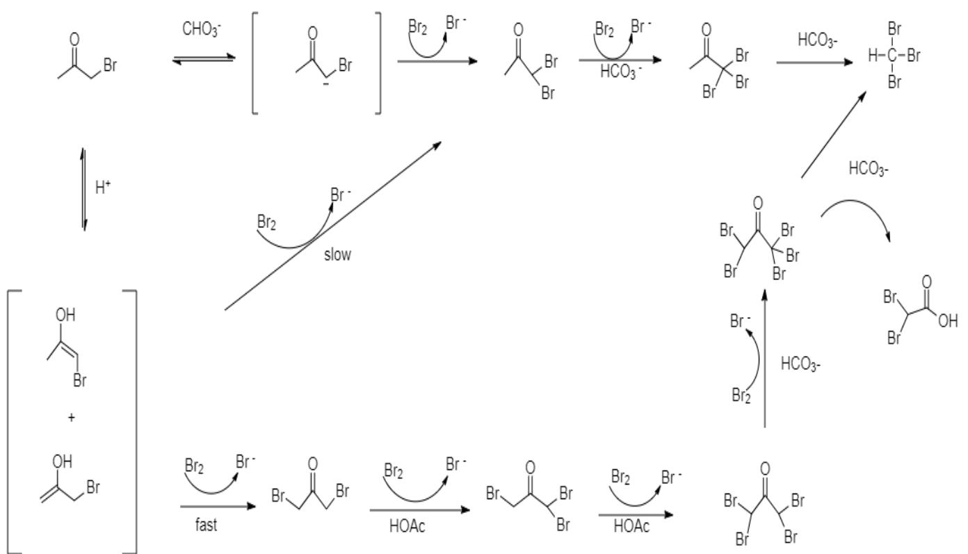
**Slika 24.** Shema neenzimskog halogeniranja halogeniranih acetona.<sup>15</sup>
