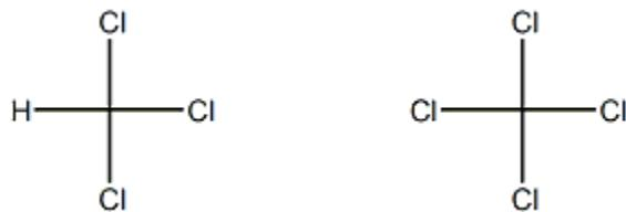
Slika 20. Strukturalna formula halogenalkana u eteričnom ulju, triklorometan i tetraklorometan.
