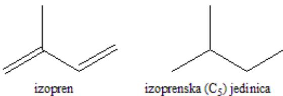
Slika 3. Strukturalna formula izoprena i izoprenske strukturne jedinica.
