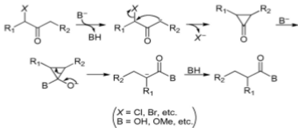
**Slika 22.** Shema Favorskii pregradnje preko ciklopropanskog prstena (formiranje karbaniona deprotoniranjem  $\alpha$ -vodika praćeno nukleofilnom supstitucijom uz nastanak ciklopropana koji dalje s bazom reagira uz otvaranje prstena i nastanak produkta).<sup>2</sup>
