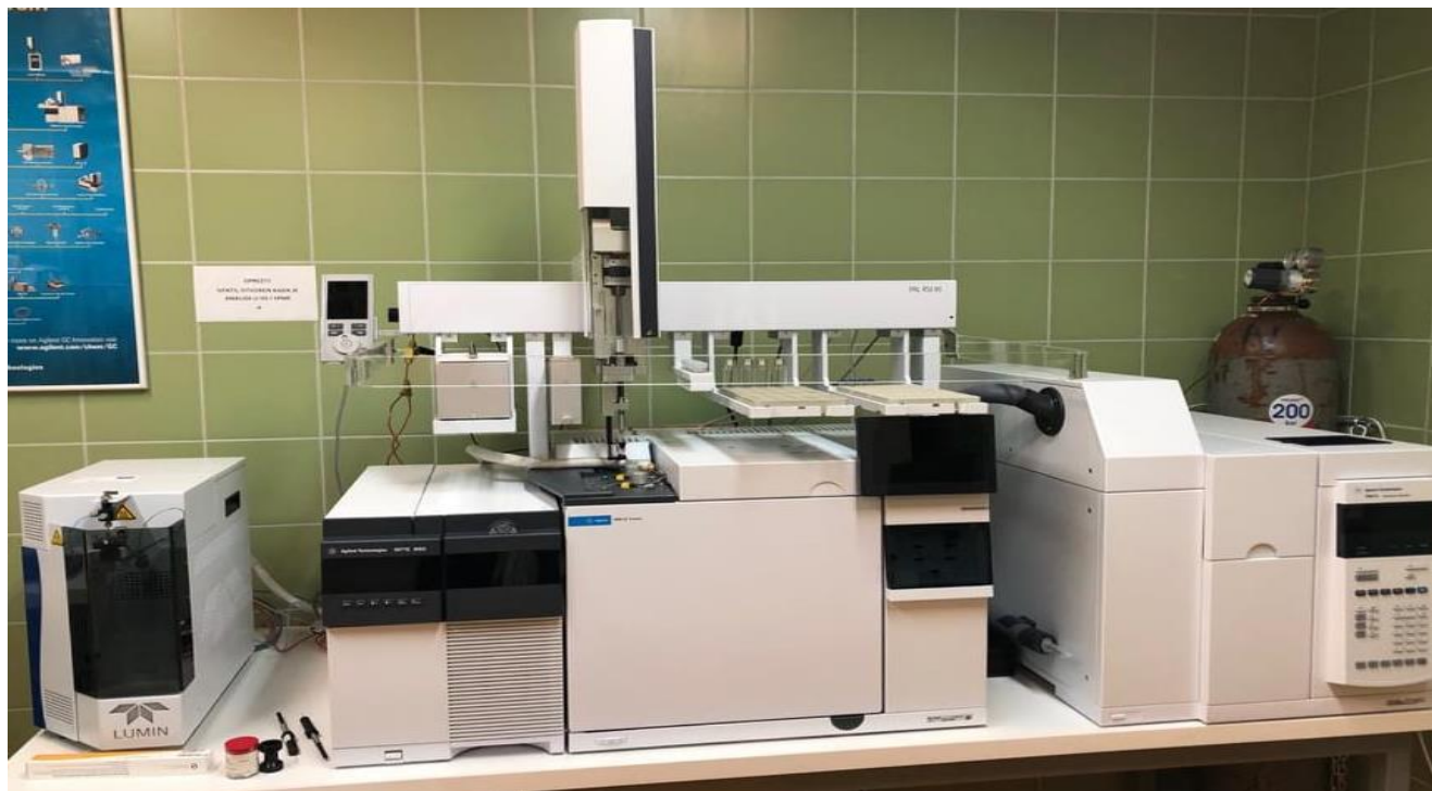
Slika 11. Vezani sustav plinska kromatografija i spektrometrija masa (GC-MS)
