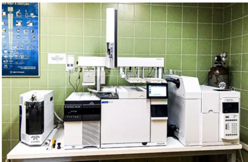
Slika 15. Vezani sustav plinska kromatografija-spektrometrija masa (GC-MS)
