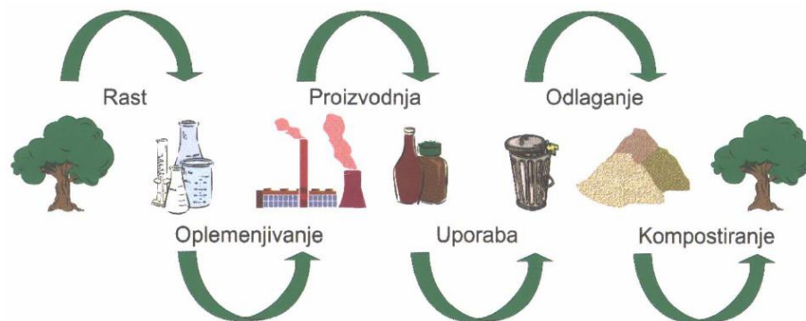
Slika 4. Životni ciklus biorazgradljivog polimernog materijala 8
