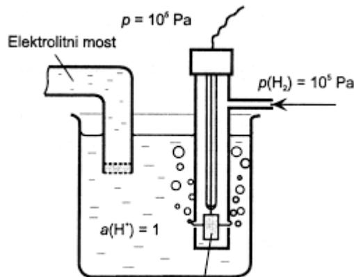
Slika 1.7. Standardna vodikova elektroda<sup>(18)</sup>
