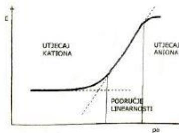
Slika 1.10. Granica detekcije elektrode<sup>(23)</sup>
