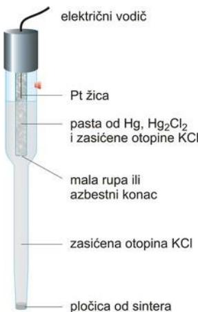
Slika 1.8. Kalomel elektroda<sup>(19)</sup>
