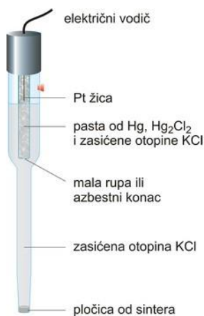
Slika 1.8. Kalomel elektroda (19)
