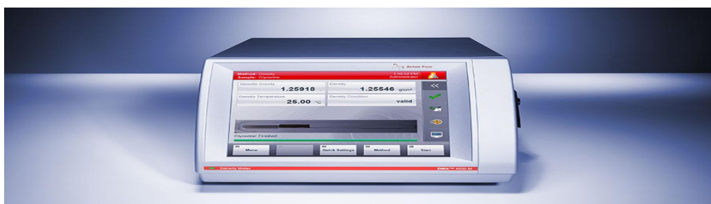
Slika 6. Mjerač gustoće s oscilirajućom U - cijevi (denzitometar) 25
