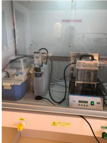
Slika 2.9. Uređaj za digestiju uzorka
