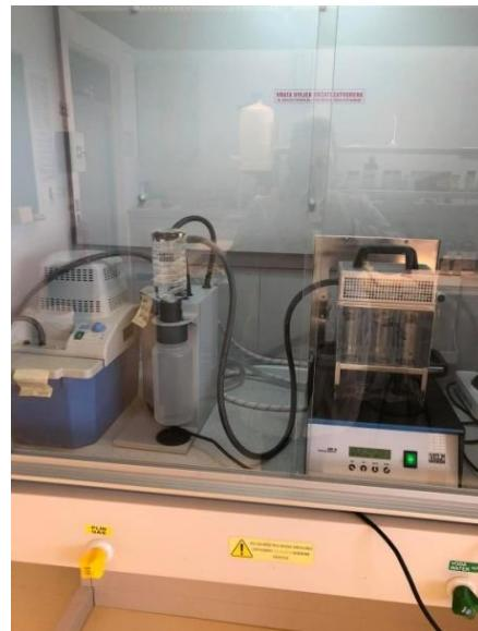
Slika 2.9. Uređaj za digestiju uzorka
