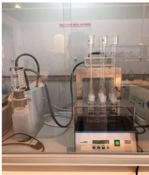
Slika 2.5. Uređaj za određivanje KPK
