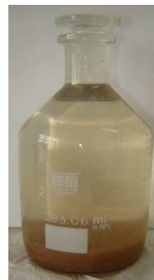
Slika 2.8. Pahuljasti talog nakon inkubacije
