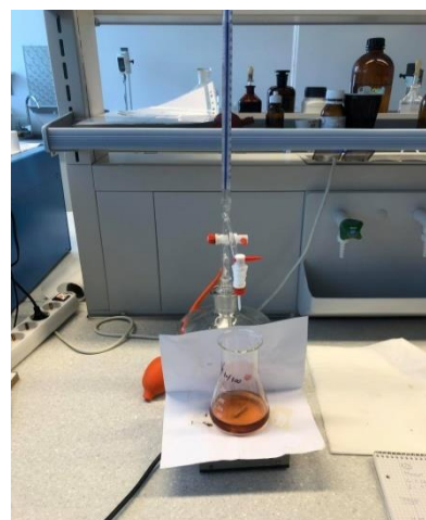
Slika 2.6. Prijelaz boje pri titraciji uzorka uz indikator feroin
