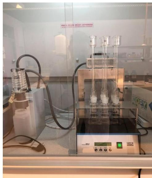
*Slika 2.5. Uređaj za određivanje KPK*
