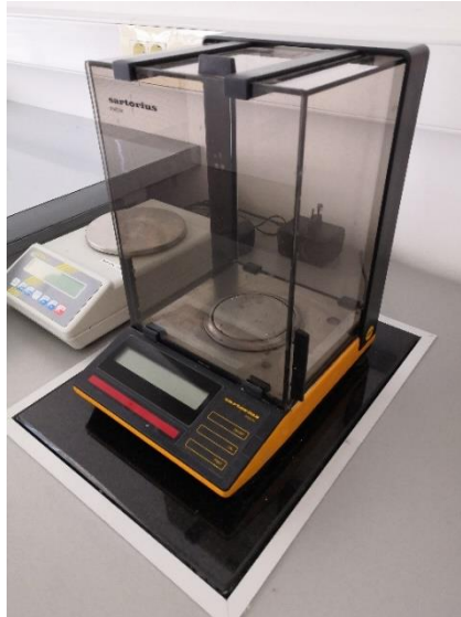
Slika 2.2. Analitička vaga Sartorius analytic
