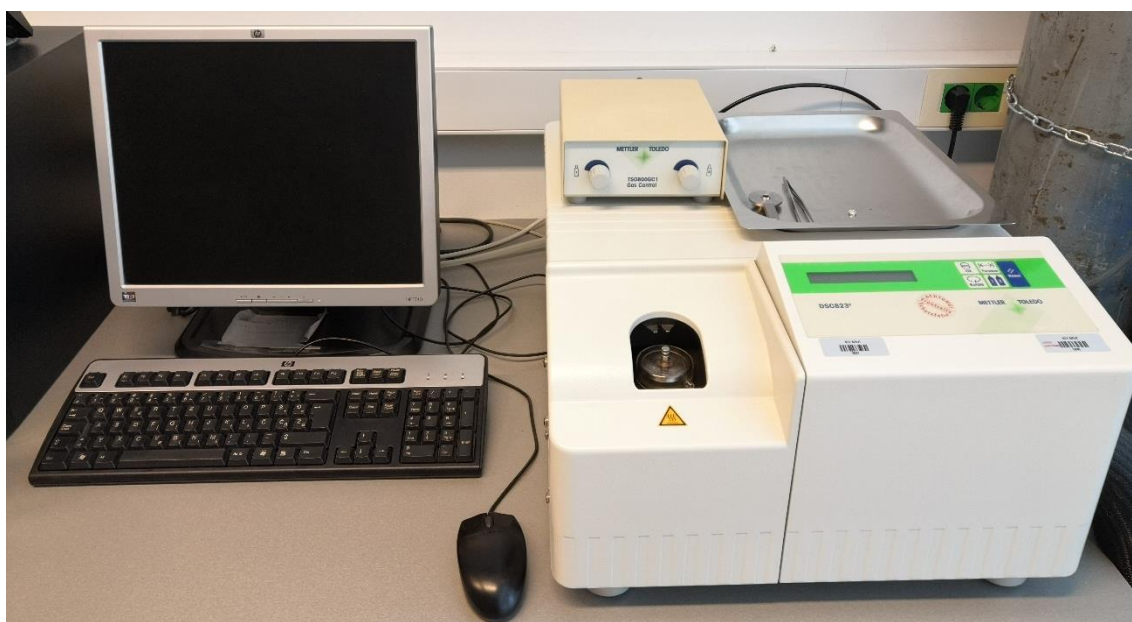
Slika 2.5. Diferencijalni pretražni kalorimetar Mettler-Toledo DSC 823 e s pratećim programom STAR e
