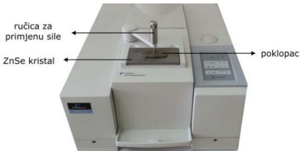
Slika 1.11. Perkin-Elmer Spectrum One spektrometar s dodatkom za snimanje HATR tehnikom 36
