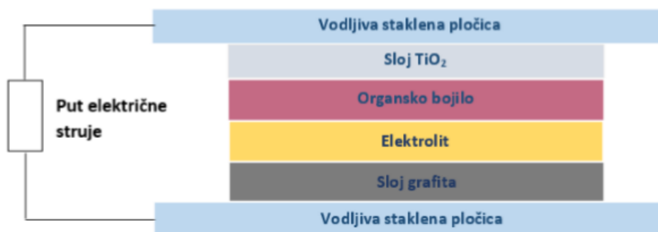
Slika 15. Struktura Grätzelove solarne ćelije 25
