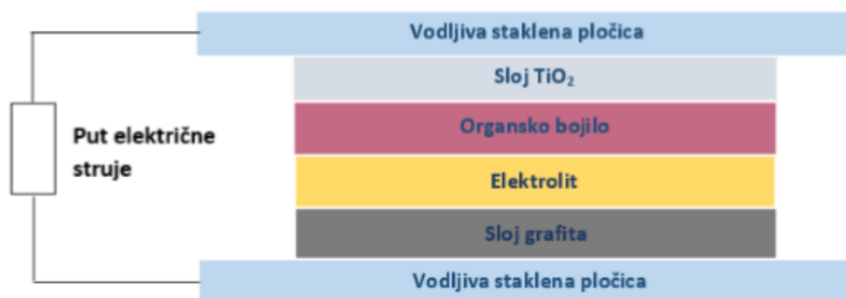
Slika 15. Struktura Grätzelove solarne ćelije 25
