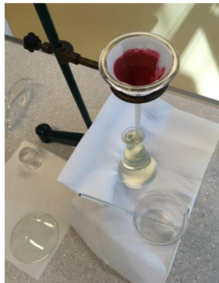
Slika 2-8 Filtracija otopine kroz lijevak
