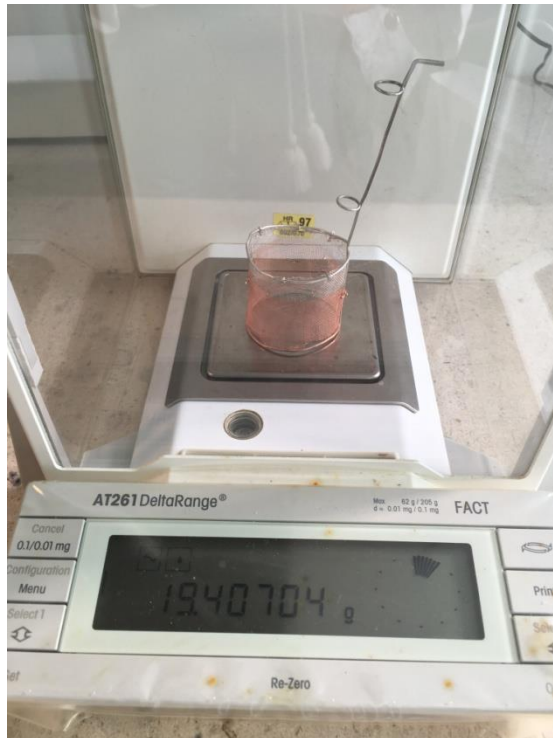
Slika 2-15a Platinska elektroda nakon elektrolize sa izlučenim bakrom; 2.15b postupak vaganja
