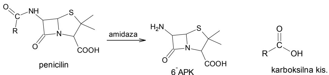
Slika 10. Enzimska hidroliza penicilina i nastajanje 6-APK
