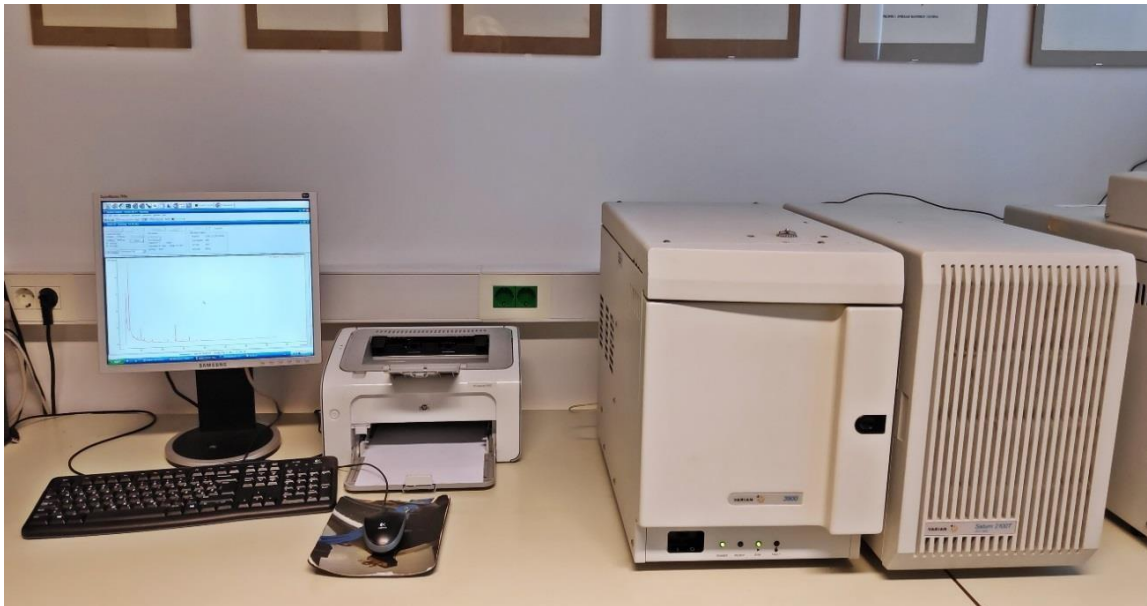
Slika 25. GC-MS uređaj (Varian, SAD).
