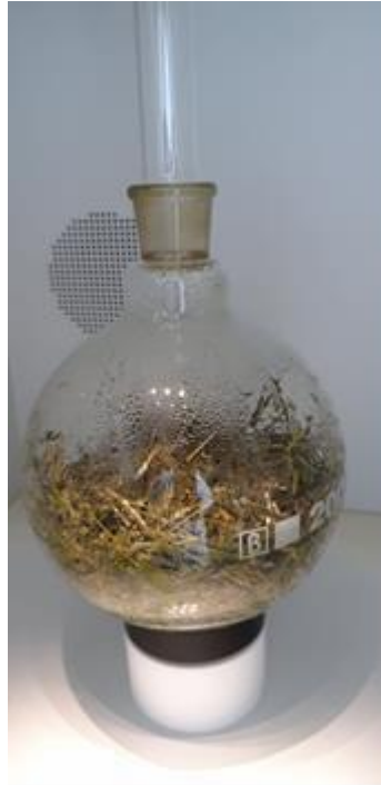
Slika 19. Biljni materijal poslije mikrovalne destilacije.
