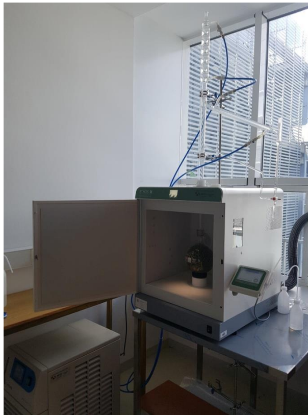
Slika 18. Uređaj za mikrovalnu destilaciju (gornji dio, engl. fragrance ).
