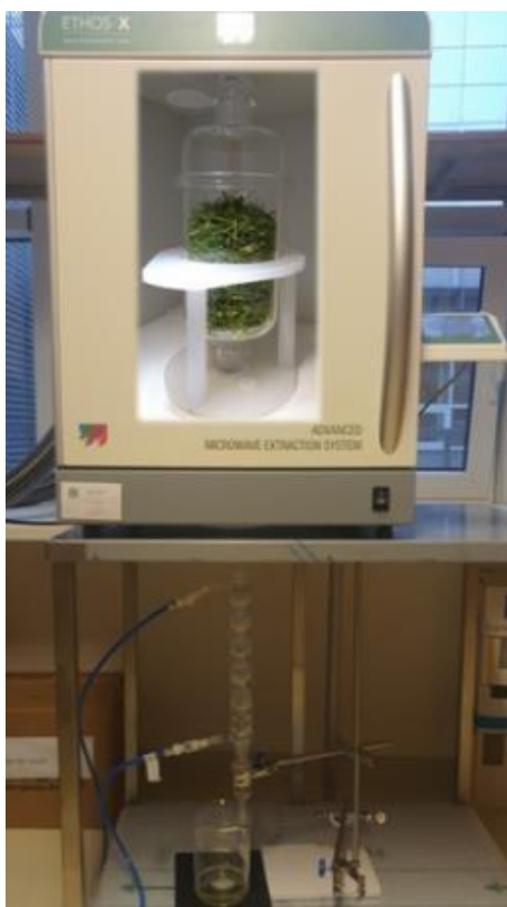
Slika 20. Mikrovalna ekstrakcija uz gravitacijsku silu (donji dio, engl. flavour ).
