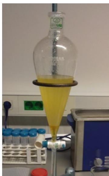
Slika 25. Obrada ekstrakta nakon mikrovalne ekstrakcije 6 .
