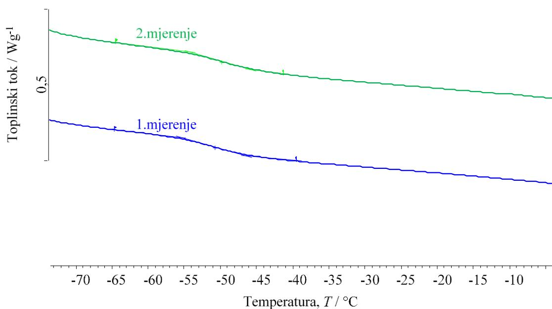
**Slika 35.** Normalizirane DSC krivulje uzorka PEO 10; staklište; 1. i 2. mjerjenje
