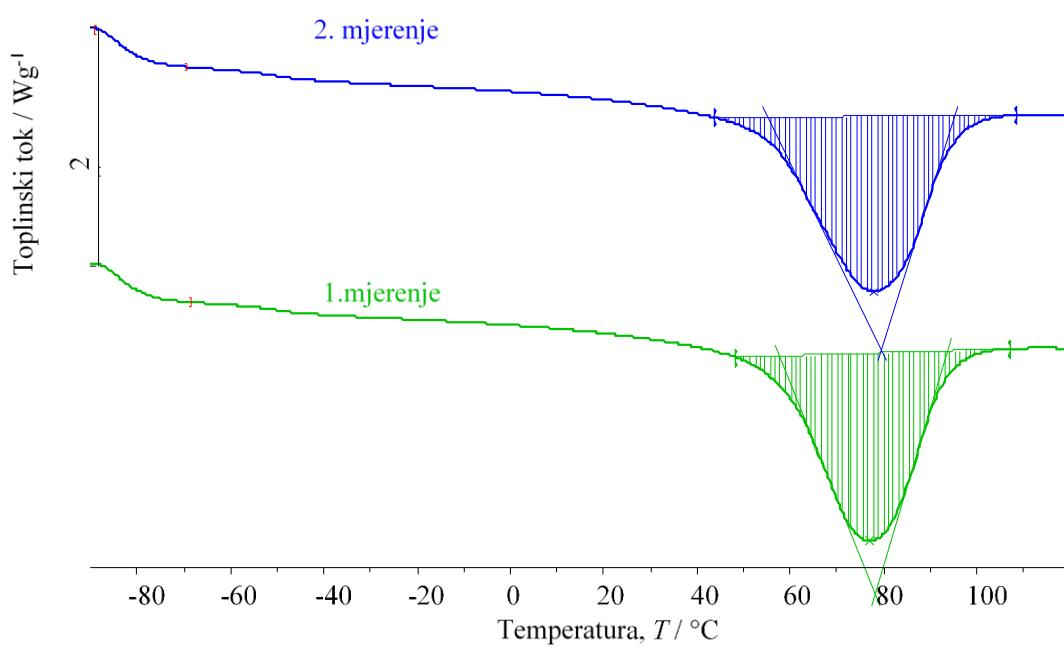
**Slika 30.** Normalizirane DSC krivulje uzorka PEO 3; taljenje; 1. i 2. mjerene
