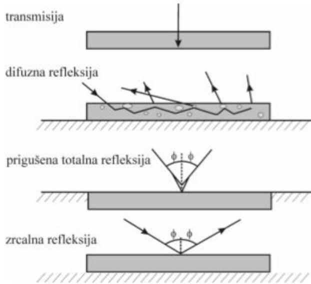
**Slika 21.** IR tehnike za različito pripremljene uzorke<sup>4</sup>
