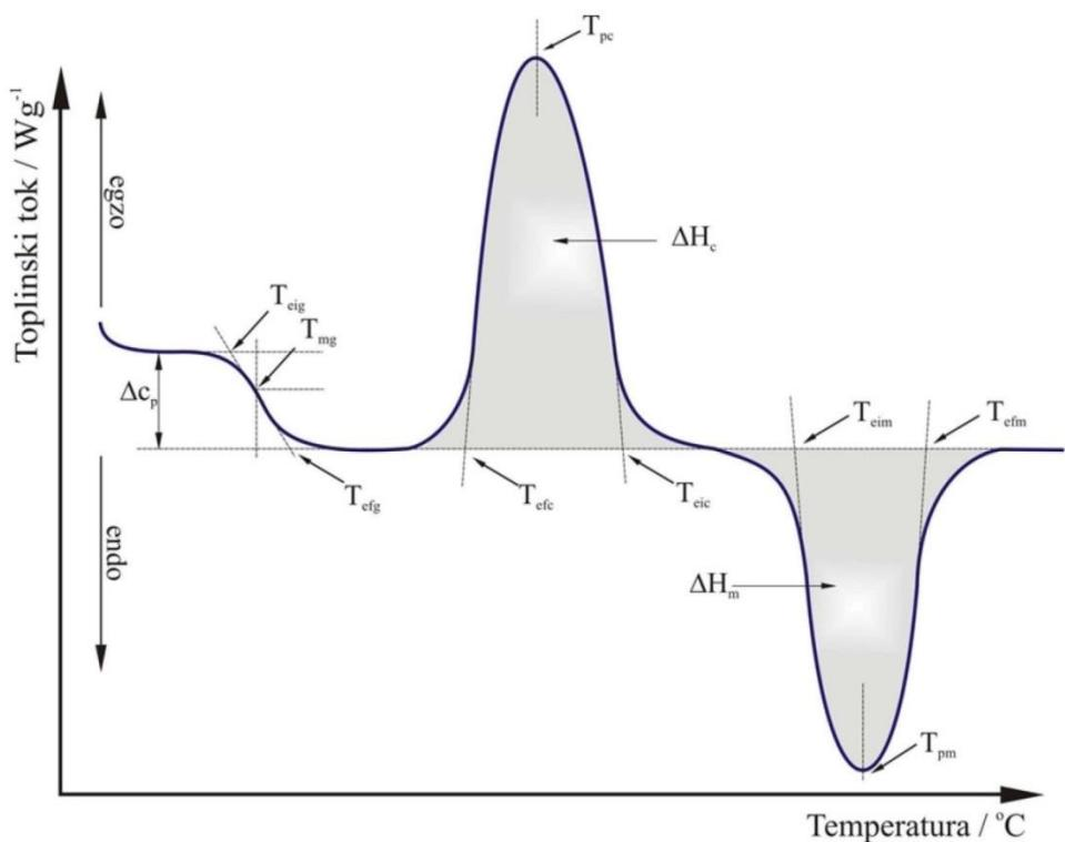
**Slika 15.** Opći prikaz DSC termograma i podataka koji se iz njega mogu odrediti<sup>21</sup>
