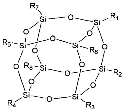
**Slika 10.** Shematski prikaz molekulske strukture POSS-a<sup>18</sup>
