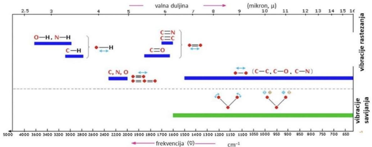
**Slika 20.** Karakteristična područja vibracija rastezanja i savijanja veze<sup>25</sup>
