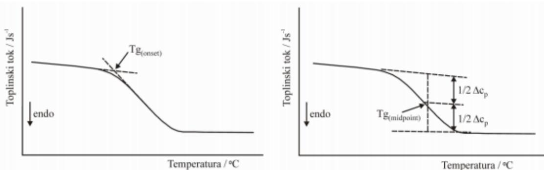
Slika 16. Određivanje staklišta iz krivulja dobivenih diferencijalnom pretražnom kalorimetrijom<sup>4</sup>
