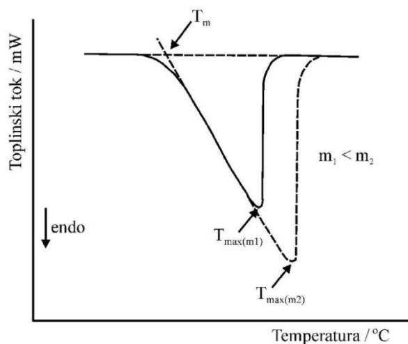
**Slika 17.** Određivanje tališta diferencijalnom pretražnom kalorimetrijom<sup>4</sup>
