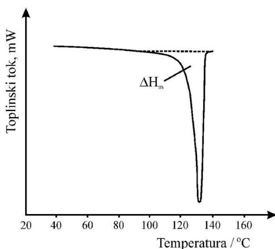
**Slika 18.** Prikaz topline taljenja dobivene diferencijalnom pretražnom kalorimetrijom<sup>4</sup>
