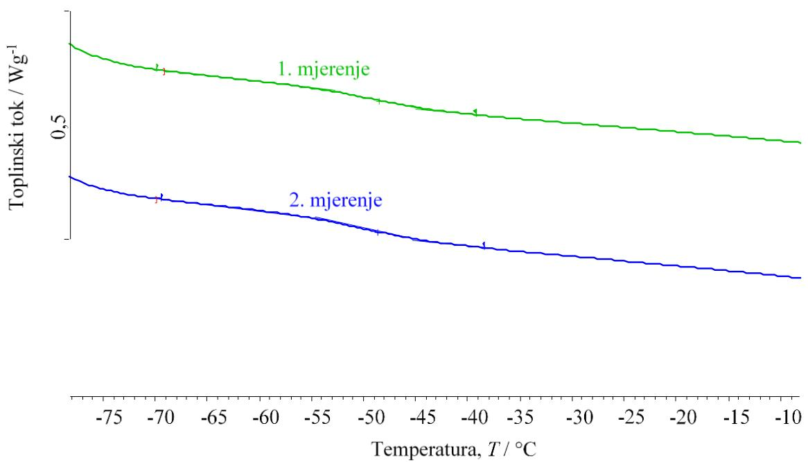
**Slika 29.** Normalizirane DSC krivulje uzorka PEO 1; staklište; 1. i 2. mjerjenje
