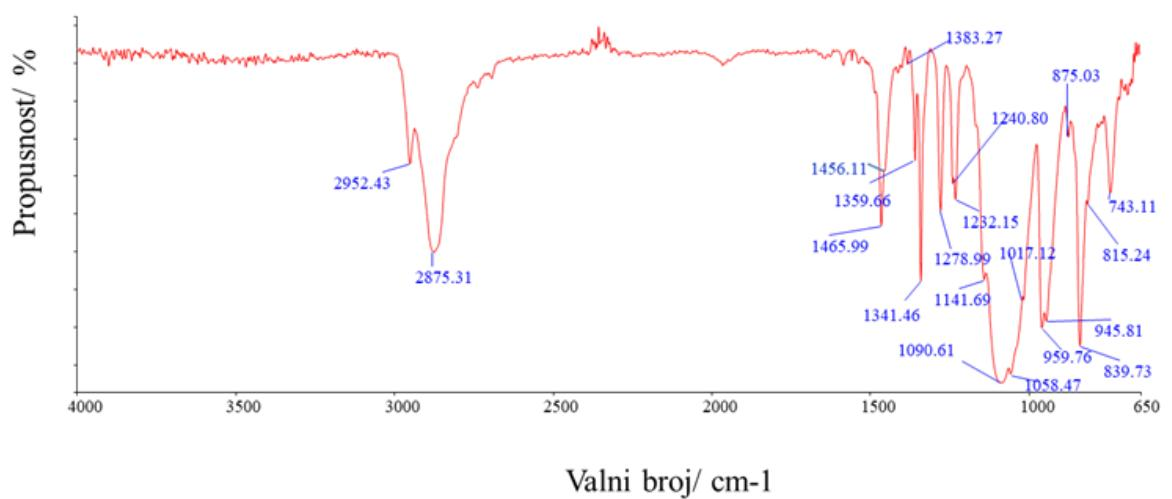
**Slika 56.** FT-IR spektrogram uzorka PEO 3/kloro f,hib-POSS nanokompozita
