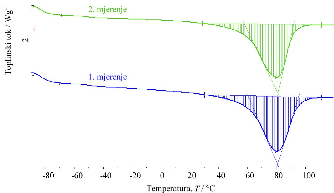
**Slika 45.** Normalizirane DSC krivulje uzorka PEO 10/kloro f,hib-POSS; taljenje; 1. i 2. mjerjenje
