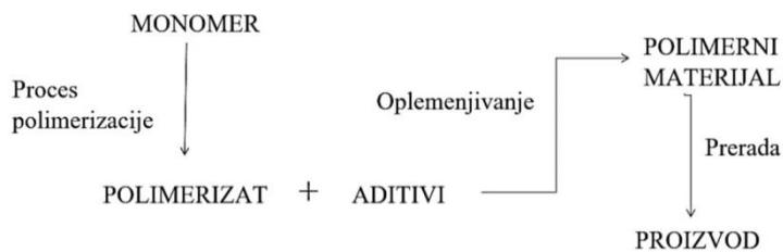
**Slika 1.** Shema dobivanja sintetskih polimernih materijala<sup>3</sup>
