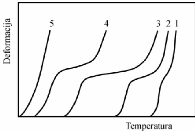
**Slika 14.** Utjecaj omekšavala na termomehaničku krivulju krutog plastomera: 1-plastomer bez omekšavala; 2, 3, 4, 5 - količina omekšavala povećava se povećanjem broja krivulje<sup>4</sup>
