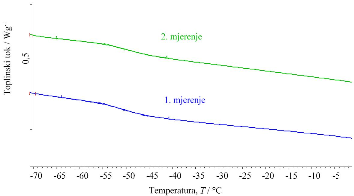
**Slika 44.** Normalizirane DSC krivulje uzorka PEO 3/kloro f,hib-POSS; staklište; 1. i 2. mjerjenje
