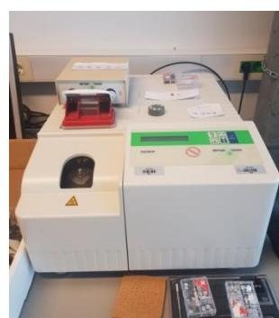
Slika 25. Diferencijalni pretražni kalorimetar
