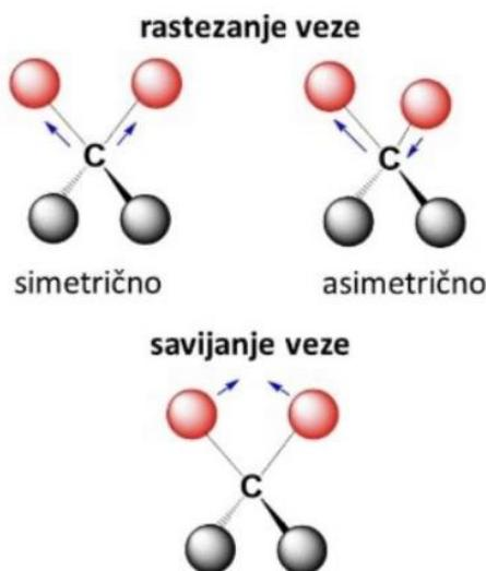
**Slika 19.** Molekulske vibracije, rastezanje i savijanje veze
