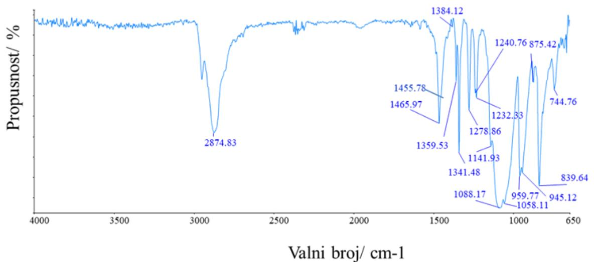
**Slika 57.** FT-IR spektogram uzorka PEO 10/kloro f,hib-POSS nanokompozita
