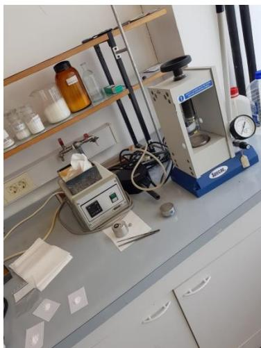
**Slika 23.** Hidraulička preša
