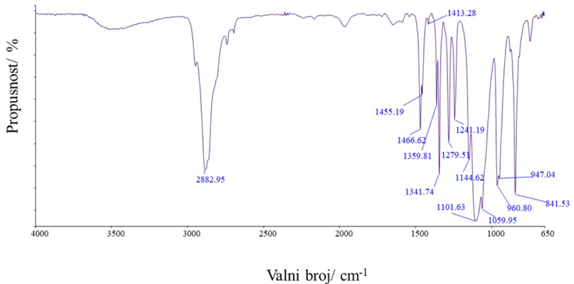
**Slika 55.** FT-IR spektrogram uzorka PEO 1/kloro f,hib-POSS nanokompozita
