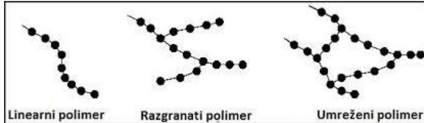
Slika 5. Podjela polimera prema obliku makromolekule 10
