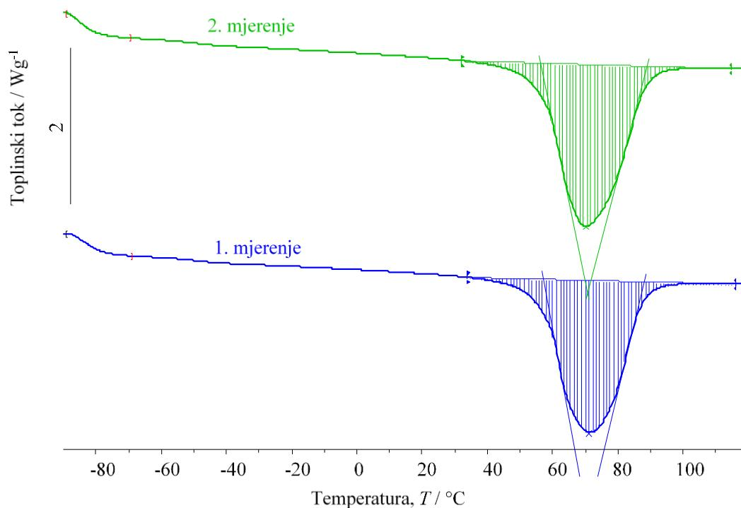
Slika 27. Normalizirane DSC krivulje uzorka PEO 1; taljenje; 1. i 2. mjereno
