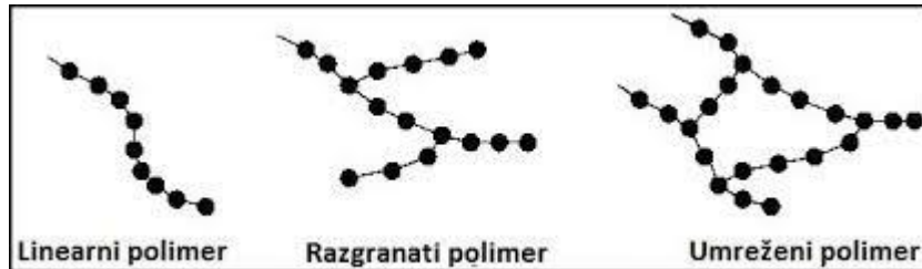
Slika 5. Podjela polimera prema obliku makromolekule 10
