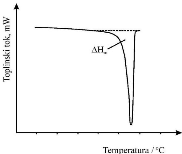
**Slika 13.** Određivanje topline taljenja<sup>5</sup>
