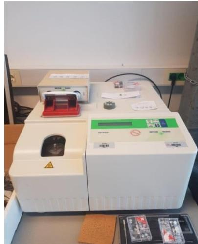
**Slika 19.** Diferencijalni pretražni kalorimetar
