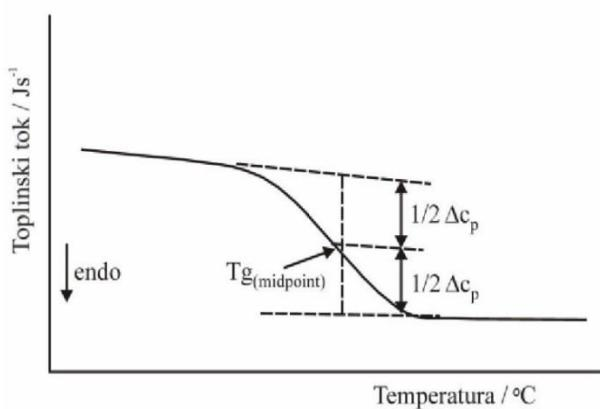
**Slika 11.** Određivanje staklišta (2. način)<sup>5</sup>
