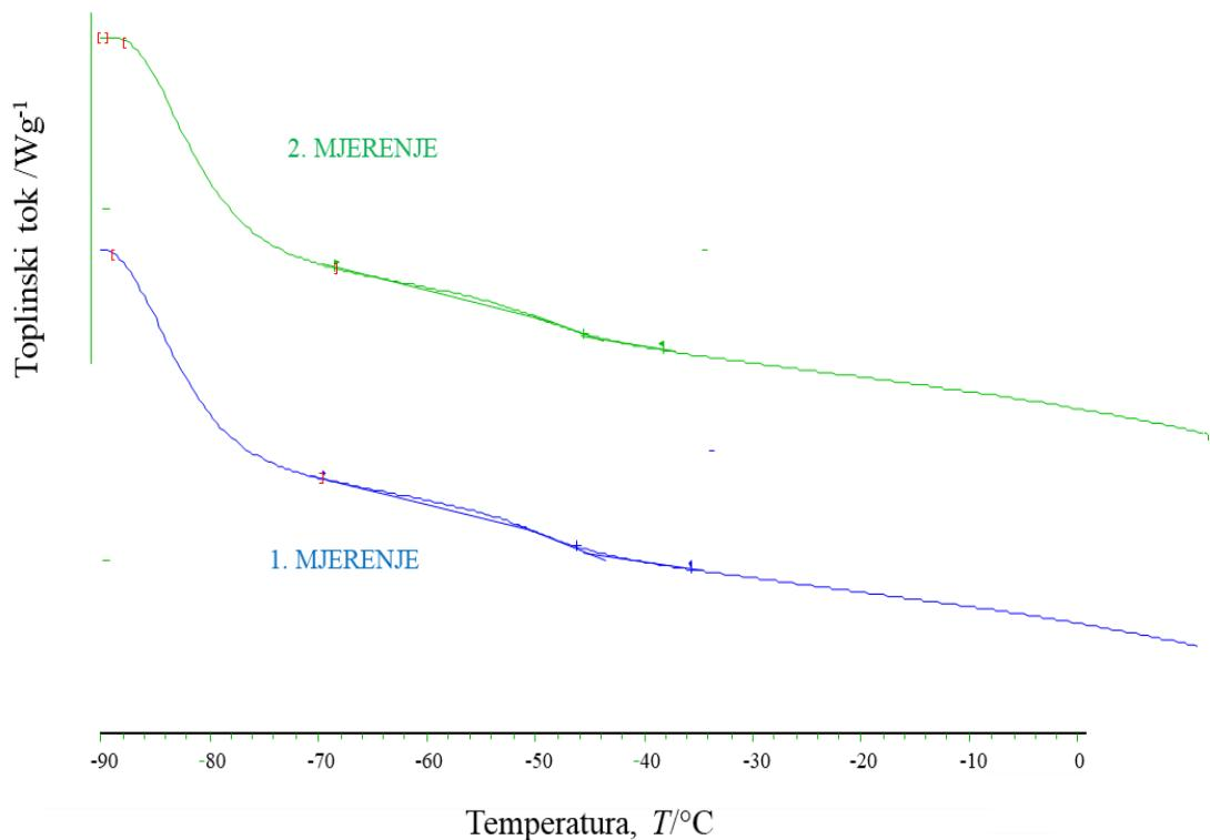
**Slika 28.** Normalizirana DSC krivulja uzorka PEO-a; staklasti prijelaz
