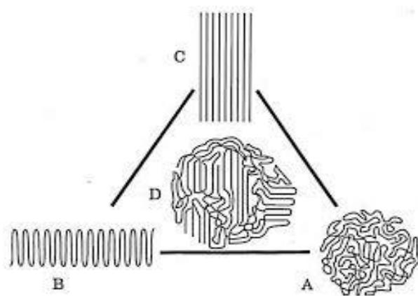
**Slika 1.** Shematski prikaz strukturne građe polimernih materijala:<sup>7</sup> **A**-amorfno, **B**-savijeno kristalno, **C**-izduženo kristalno, **D**-amorfno kristalno
