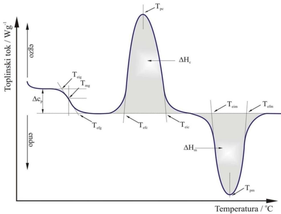
Slika 9. Opći prikaz DSC termograma<sup>18</sup>
