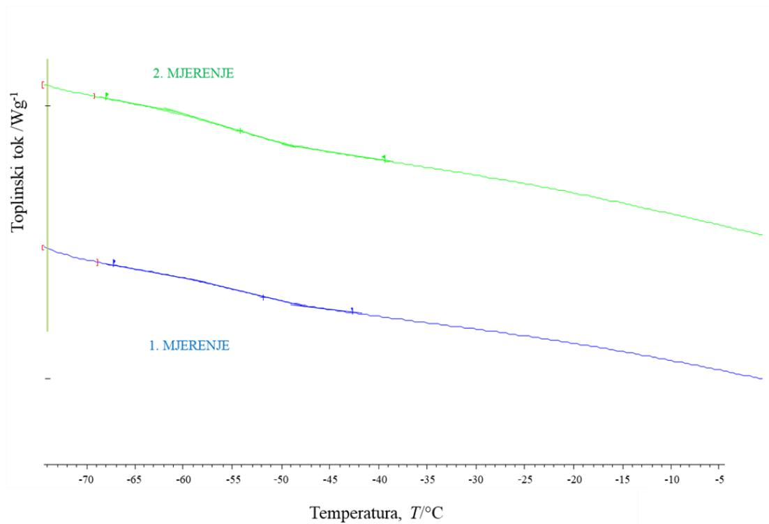
**Slika 34.** Normalizirana DSC krivulja uzorka PEO/PEG POSS\_5%; staklasti prijelaz
