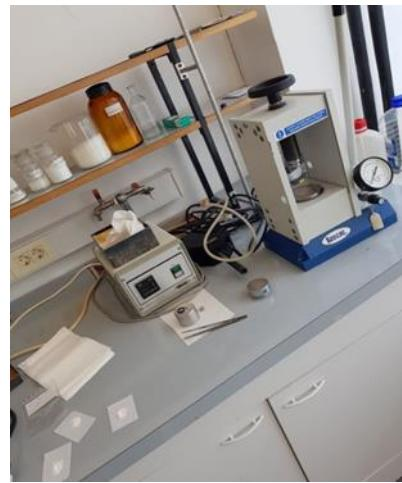
**Slika 15.** Hidraulička preša
