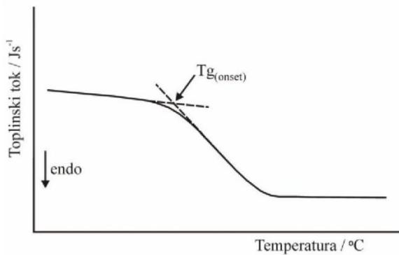
**Slika 10.** Određivanje staklišta (1. način)<sup>5</sup>
