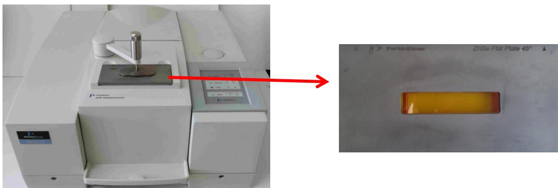
Slika 18. FTIR spektrofotometar s dodatkom za snimanje uzorka HATR tehnikom
