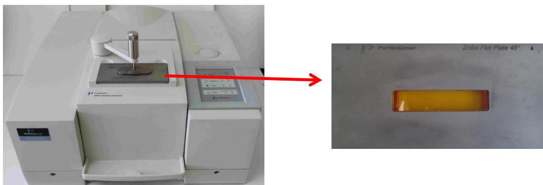
Slika 18. FTIR spektrofotometar s dodatkom za snimanje uzorka HATR tehnikom
