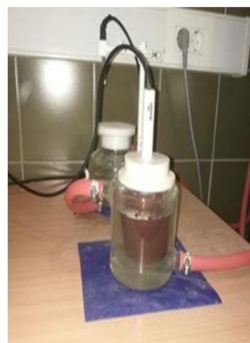
Slika 6. Mjerna posuda s uzorkom i uronjenom elektrodom
