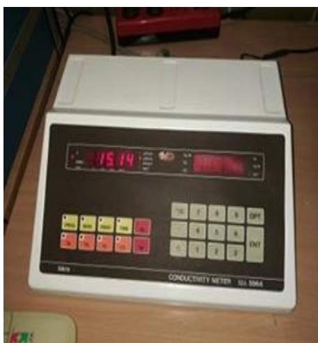
Slika 5. Konduktometar Iskra MA 5964
