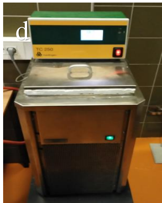
Slika 10. : Aparatura za određivanje specifične električne provodnosti a) uz prikaz konduktometra ISKRA MA-5964 b) te elektrode od nehrđajućeg čelika i staklene posude s dvostrukom stijenkom c) te termostat d)
