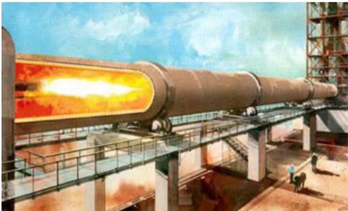
Slika 5. Rotacijska peć za proizvodnju klinkera 5
