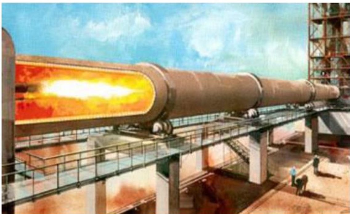
Slika 5. Rotacijska peć za proizvodnju klinkera 5
