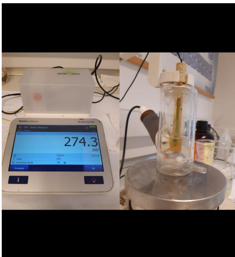
Slika 12. Milivoltmetar koji prikazuje izmjereni potencijal (lijevo) i referentna elektroda uronjena u ćeliju s magnetskom miješalicom (desno)
