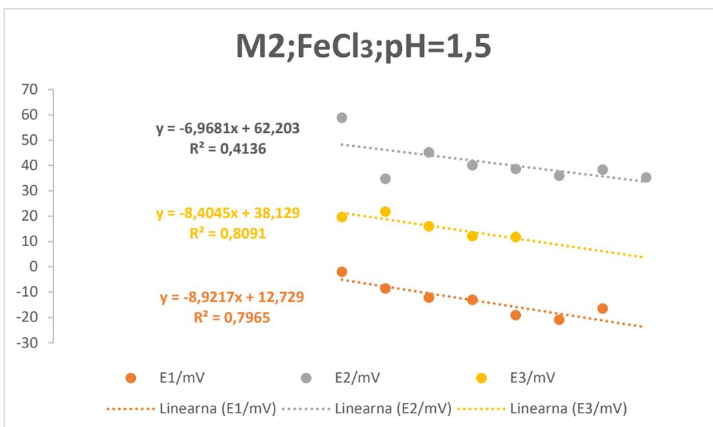
**Slika 13.** Prikaz testiranja odziva elektrode na Fe<sup>3+</sup> ione u otopini željezovog(III) klorida pri pH=1,5
