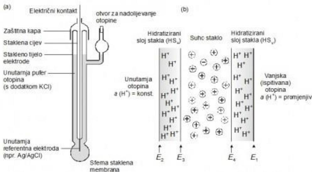
**Slika 9.** Prikaz staklene elektrode (a) i presjek kroz staklenu membranu (b)<sup>1</sup>
