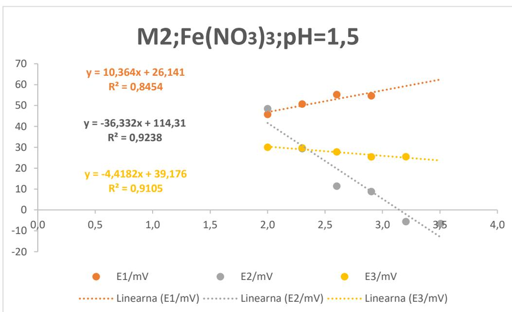
**Slika 12.** Prikaz testiranja odziva elektrode na  $\text{Fe}^{3+}$  ione u otopini željezovog(III) nitrata pri  $\text{pH}=1,5$
