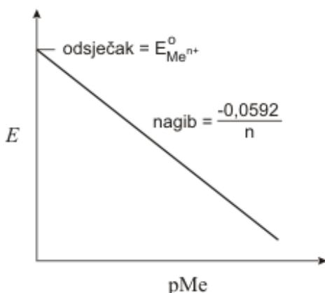
**Slika 6.** Linearna ovisnost koncentracije metalnih iona o potencijalu elektrode I. reda<sup>3</sup>
