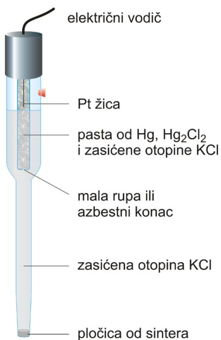
**Slika 4.** Zasićena kalomelova elektroda<sup>5</sup>
