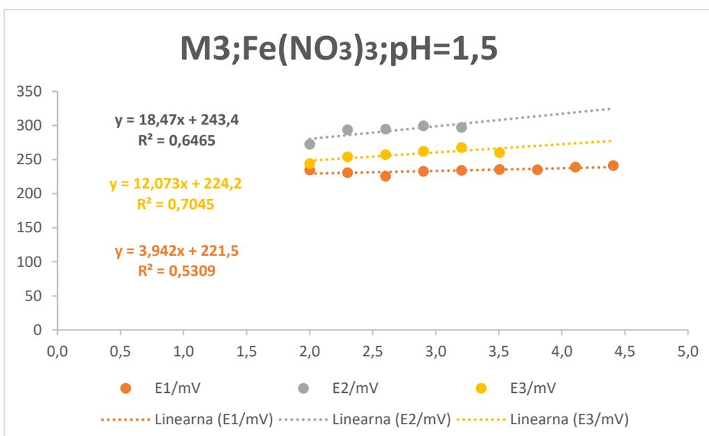
**Slika 14.** Prikaz testiranja odziva elektrode na Fe<sup>3+</sup> ione u otopini željezovog(III) nitrata pri pH=1,5
