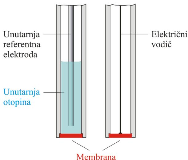
**Slika 8.** Shematski prikaz elektrode s kristalnom membranom<sup>5</sup>
