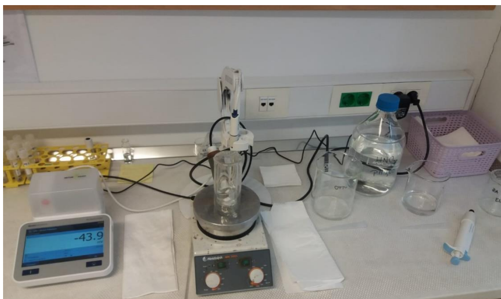
Slika 11. Prikaz aparature za potenciometrijsko mjerenje
