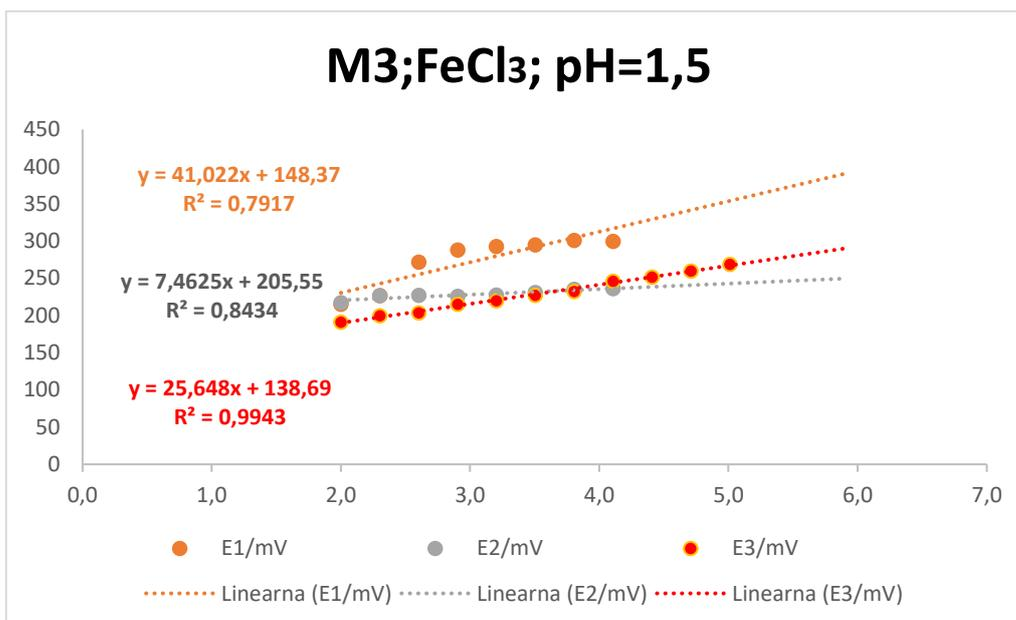
**Slika 15.** Prikaz testiranja odziva elektrode na Fe<sup>3+</sup> ione u otopini željezovog(III) klorida pri pH=1,5
