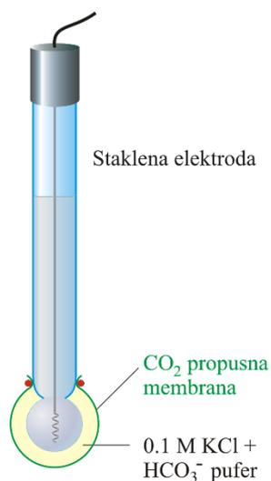
**Slika 10.** Prikaz elektrode za plinove<sup>5</sup>
