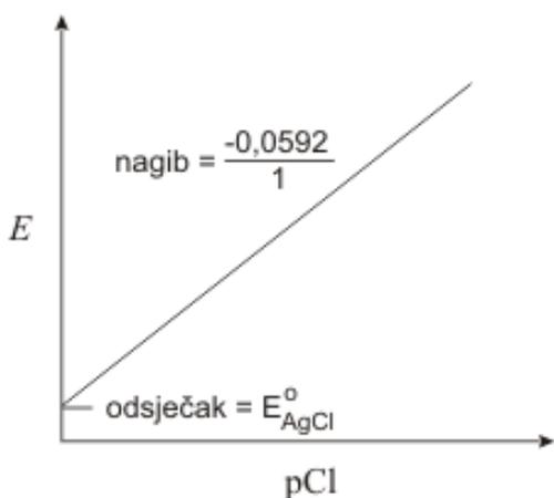
*Slika 7.* Linearna ovisnost koncentracije metalnih iona o potencijalu elektrode II. reda<sup>5</sup>
