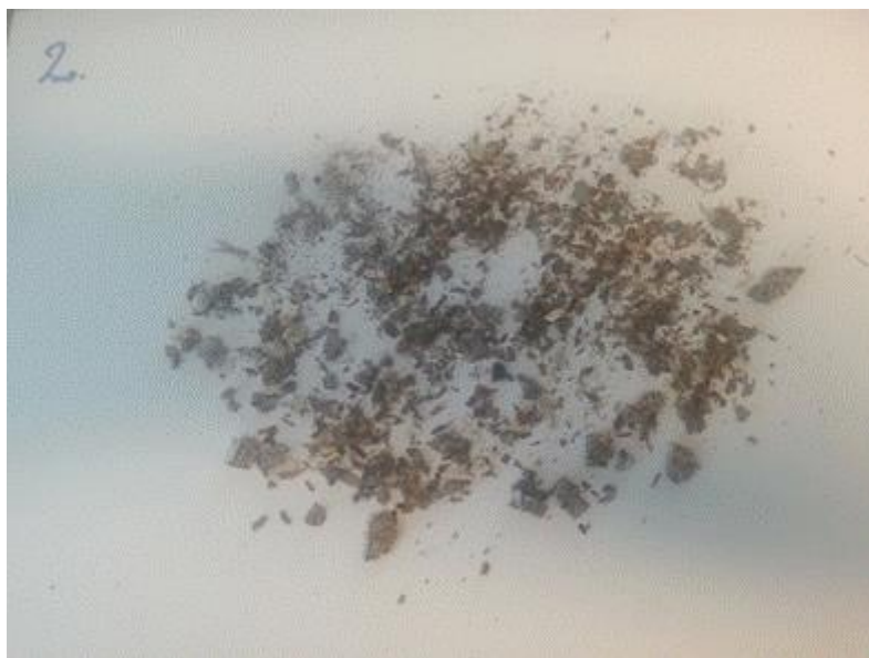
Slika 16. Osušeni uzorci PLA (sitni svjetliji komadići) iz reaktora 2
