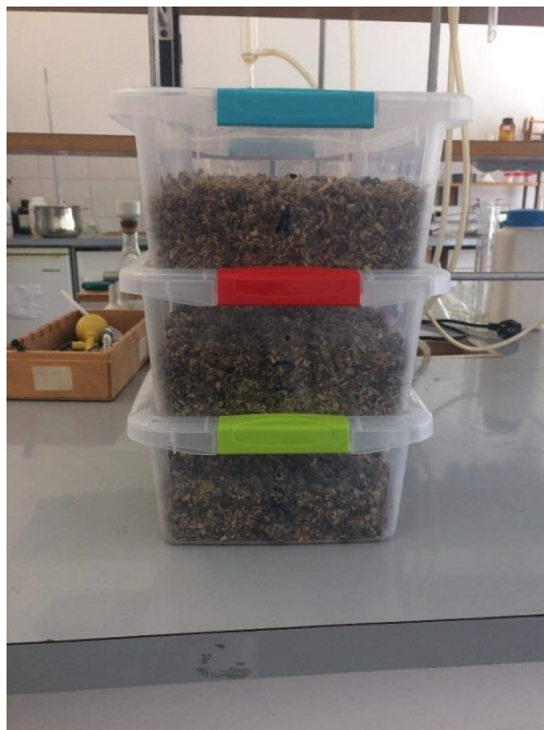
Slika 12. Vanjski izgled reaktora za kompostiranje
