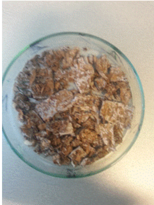
Slika 13. PLA uzorci nakon kompostiranja i sušenja
