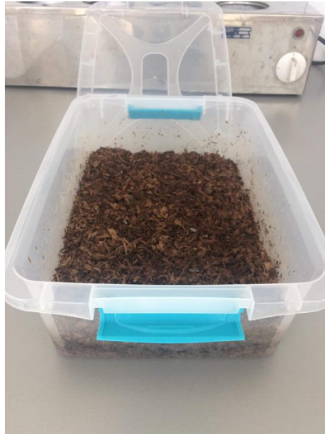
Slika 11. Reaktor za kompostiranje sa supstratom
