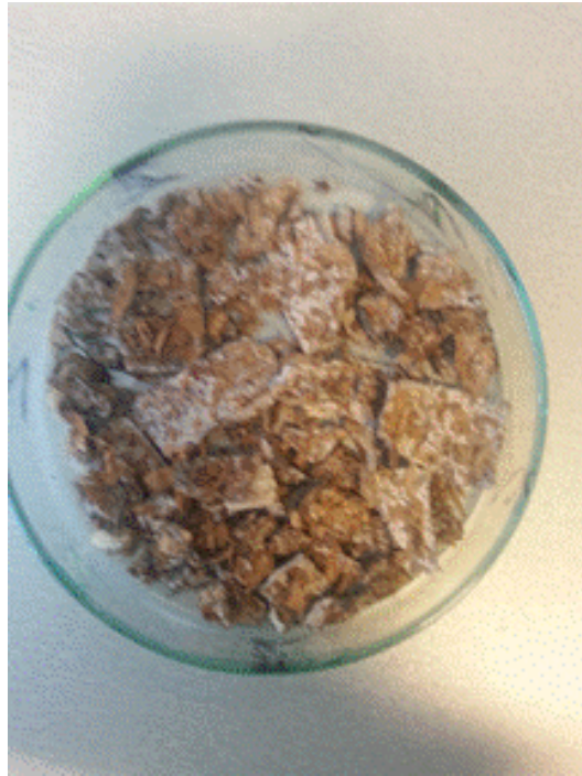
Slika 13. PLA uzorci nakon kompostiranja i sušenja
