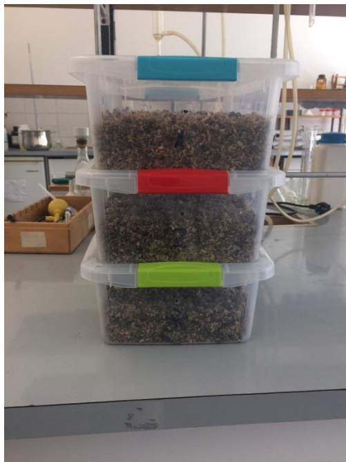
Slika 12. Vanjski izgled reaktora za kompostiranje
