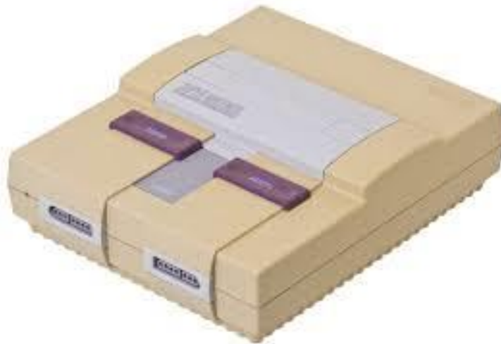
Slika 1. Žućenje plastičnog materijala 4
