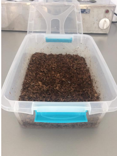
Slika 11. Reaktor za kompostiranje sa supstratom
