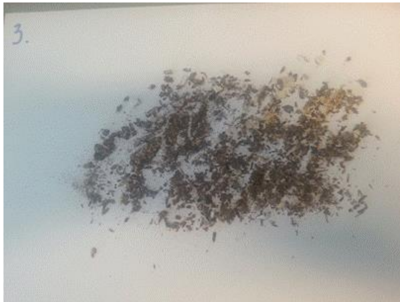
Slika 17. Osušeni uzorci PLA (sitni svjetliji komadići) iz reaktora 3
