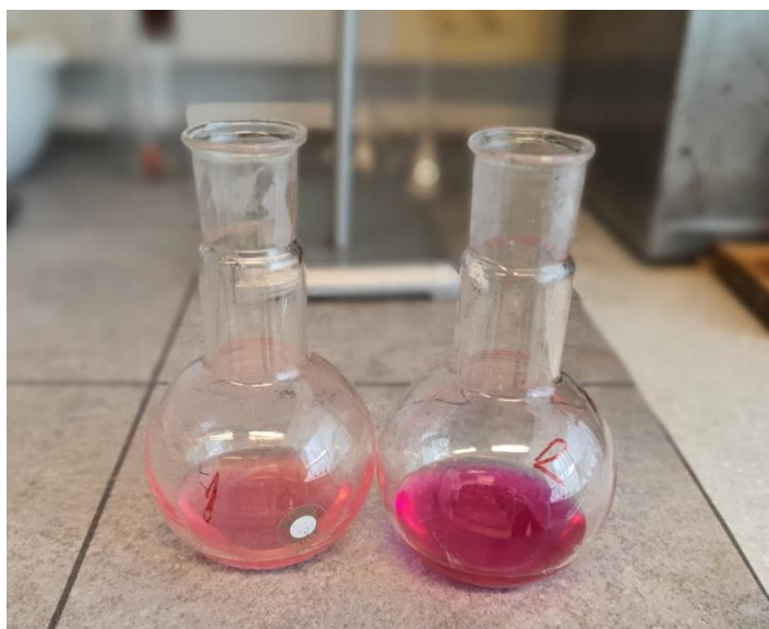
Slika 14. Uzorci nakon titracije s KOH
