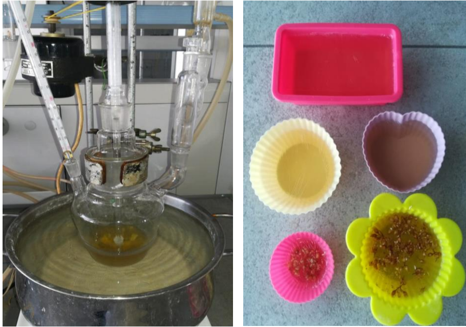
Slika 12. Aparatura za pripravu sapuna i kalupi s izlivenom sapunskom smjesom
