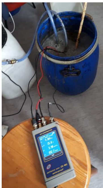
Slika 2.7. Simulirajući SBR reaktor s dva difuzora.
