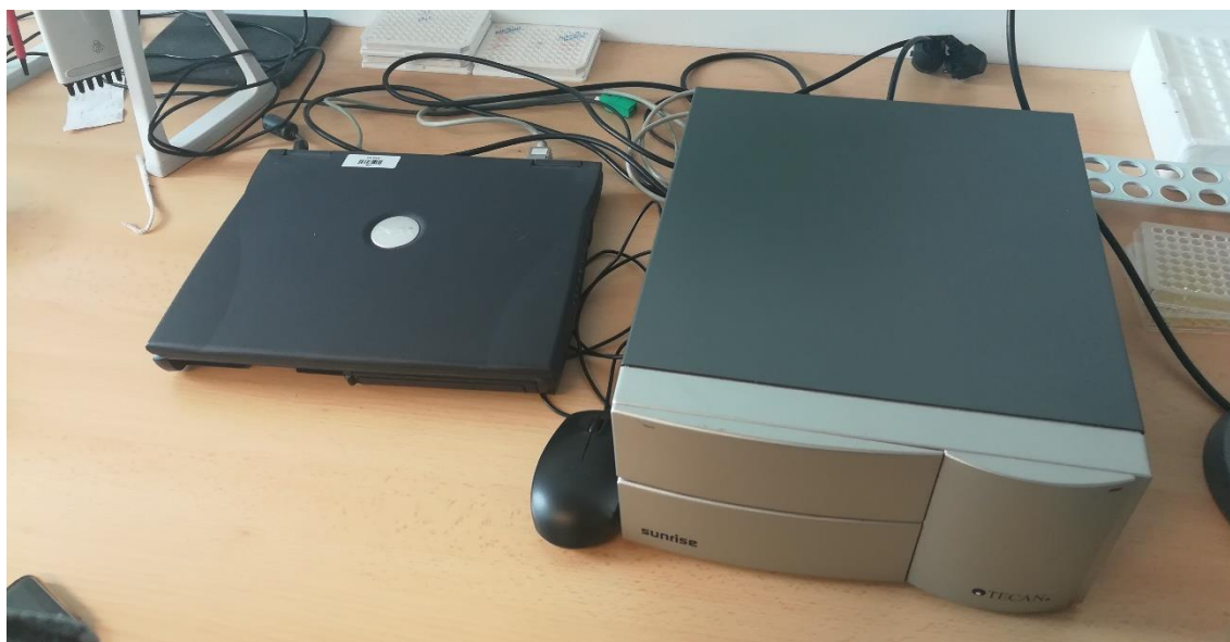
Slika 20. Višekanalni spektrofotometrijski čitač mikrotitarskih pločica 'Sunrise'
