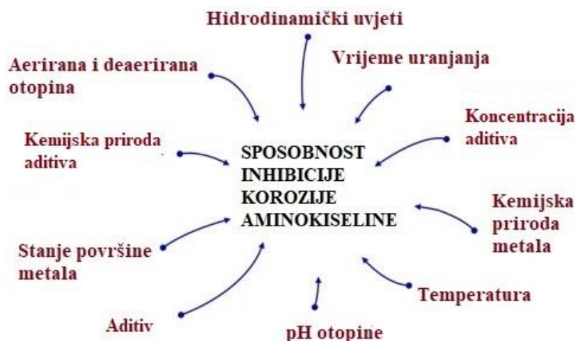
Slika 13. Faktori koji utječu na učinke djelovanja inhibitora korozije. 18
