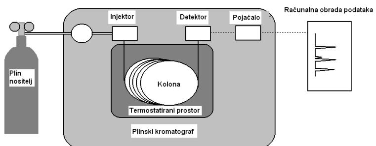
Slika 10. Shematski prikaz plinskog kromatografa
