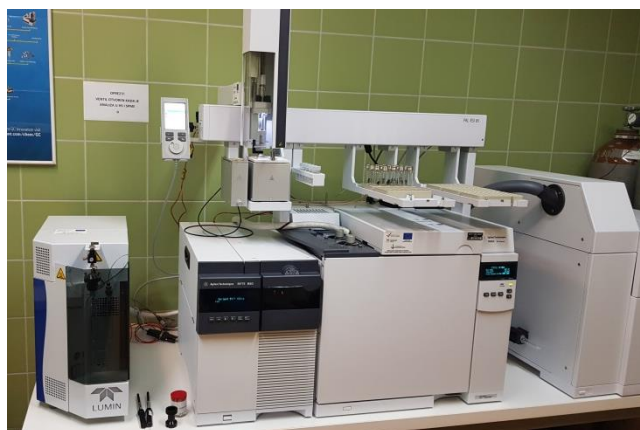
Slika 26. Vezani sustav plinska kromatografija-spektrometrija masa (GC-MS)
