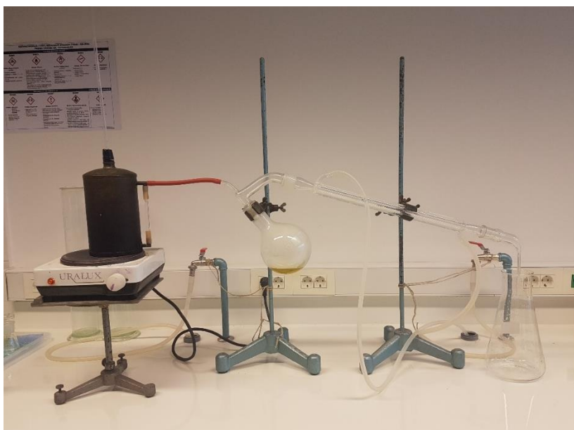
Slika 22. Destilacija vodenom parom
