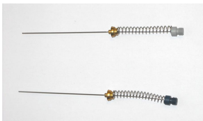
Slika 25. Vlakna s ovojnicama DVB/CAR/PDMS (sivo vlakno) i PDMS/DVB (plavo vlakno)
