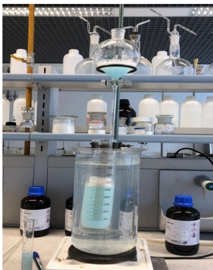
Slika 17. Aparatura za određivanje moći pjenjenja
