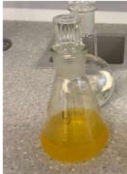
Slika 13. Titracija alkalija u vodenom sloju
