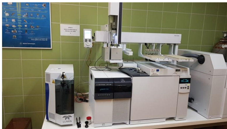
Sika 22. Vezani sustav plinska kromatografija-spektrometrija masa (GC-MS)
