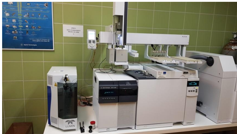
Sika 22. Vezani sustav plinska kromatografija-spektrometrija masa (GC-MS)
