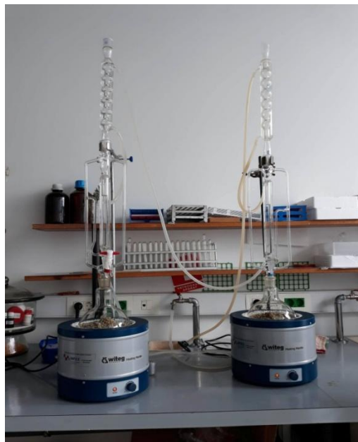
Slika 20. Serijski spojene aparature po Clevengeru
