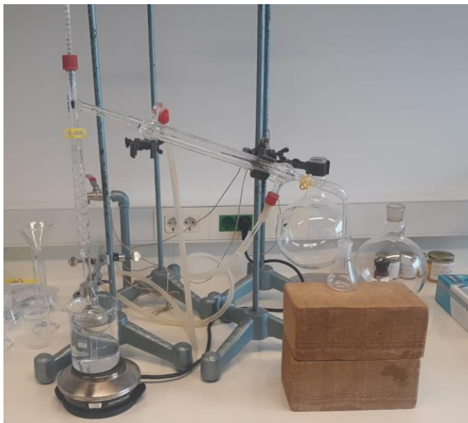
Slika 2.9. Koncentriranje ekstrakata frakcijskom destilacijom
