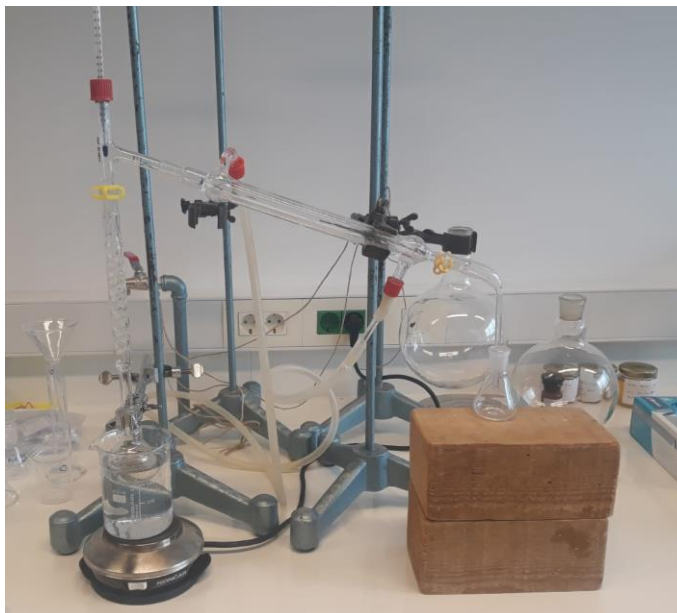
Slika 2.9. Koncentriranje ekstrakata frakcijskom destilacijom
