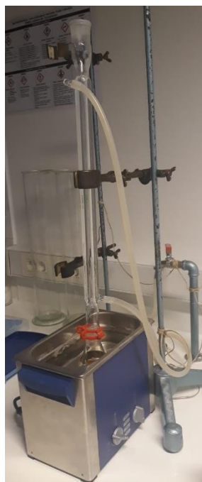
Slika 2.6. Aparatura za ultrazvučnu ekstrakciju
