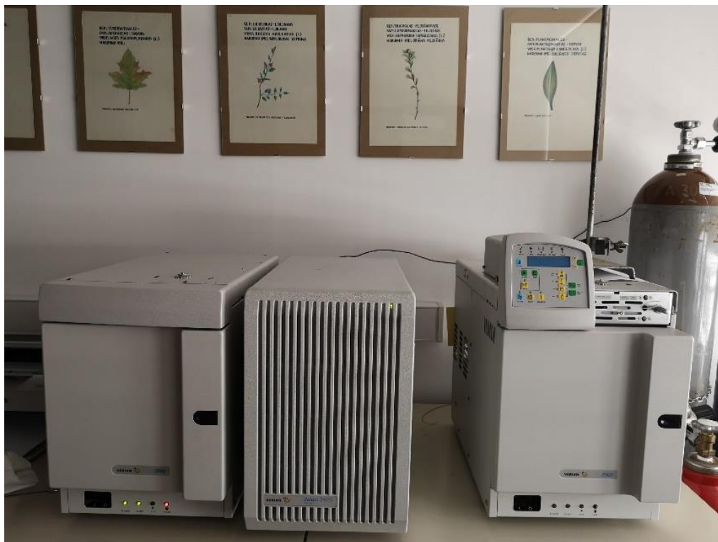
Slika 11: Vezani sustav plinska kromatografija – spektrometrija masa (GC/MS)
