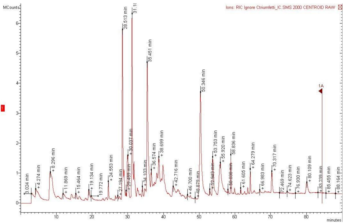
**Slika 12: Kromatogram ukupne ionske struje eteričnog ulja *C. triumphfetti***
