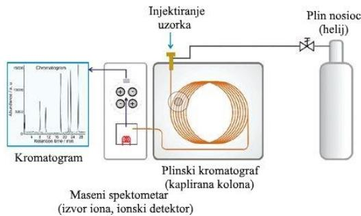
**Slika 7: Shematski prikaz GC/MS analize<sup>(14)</sup>**
