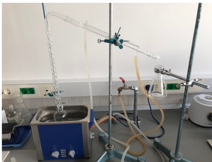
Slika 9. Ultrazvučna ekstrakcija (USE)
