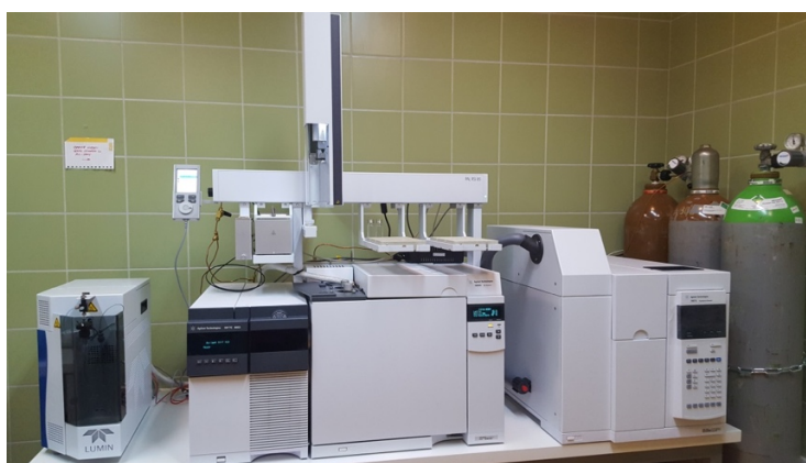
Slika 10. Vezani sustav plinska kromatografija-spektrometrija masa (GC-MS)
