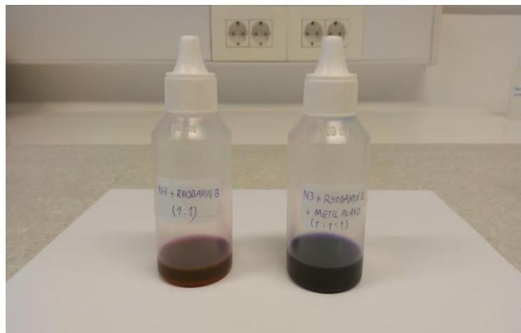
Slika 20. Pripravljene smjese bojila: N3 + rhodamin B i N3 + rhodamin B + metil plavo
