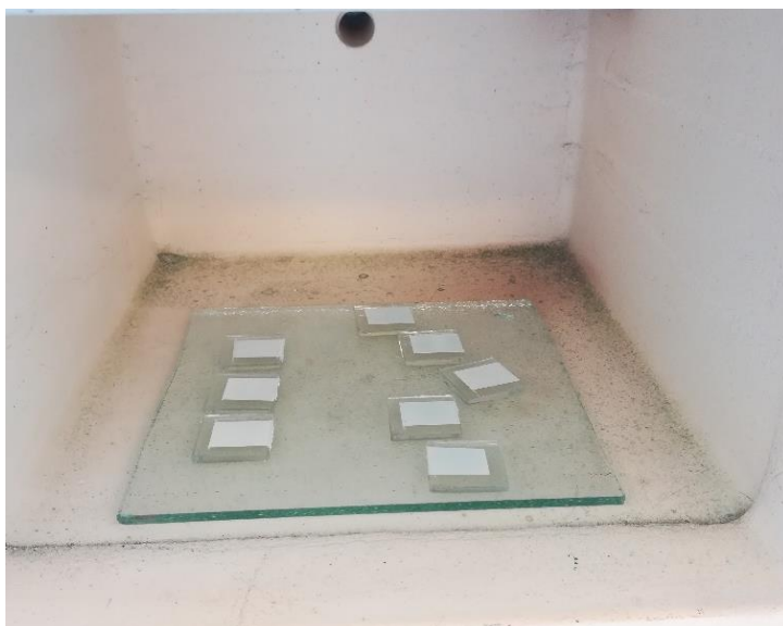
Slika 25. Pečenje oksidnog sloja u laboratorijskoj peći
