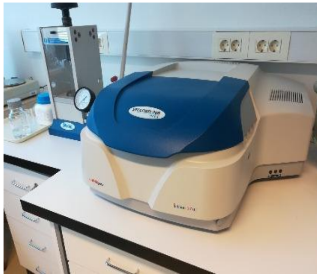
Slika 31. UV – Vis spektrofotometar, Specord 200 Plus
