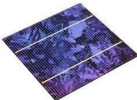
Slika 5. Polikristalna silicijska solarna ćelija 9
