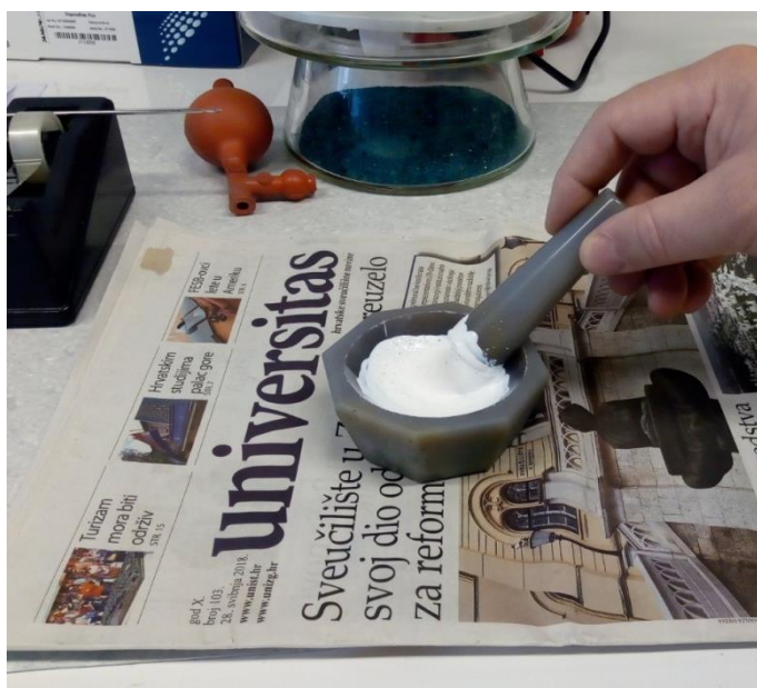
Slika 21. Priprava \text{TiO}_2 paste
