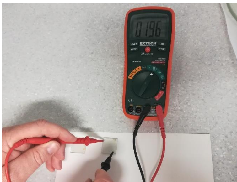
Slika 22. Određivanje vodljive strane stakalca pomoću multimetra
