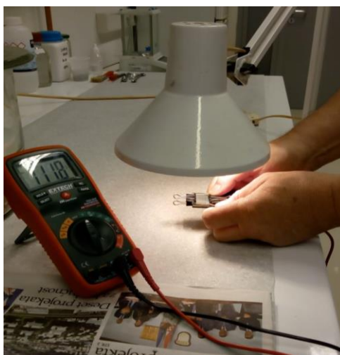
Slika 30. Mjerenje fotoinduciranog napona pri umjetnom osvjetljenju pomoću multimetra
