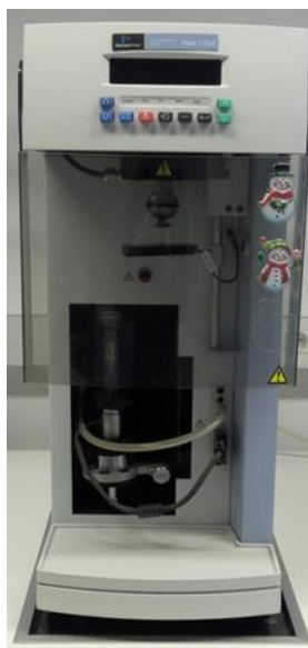
Slika 11. Pyris 1 TGA (Perkin-Elmer) termogravimetar
