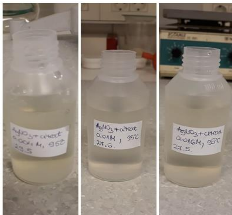
Slika 8. Uzorci koloidnog srebra dobivenog zelenim postupkom pomoću trinatrijevog citrata dihidrata, poredani s lijeva na desno počevši s najnižom koncentracijom, pri 95 °C
