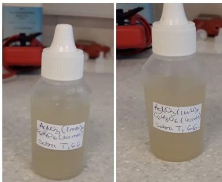
Slika 10. Uzorci koloidnog srebra dobivenog zelenim postupkom s askorbinskom kiselinom, sintezom pri sobnoj temperaturi
